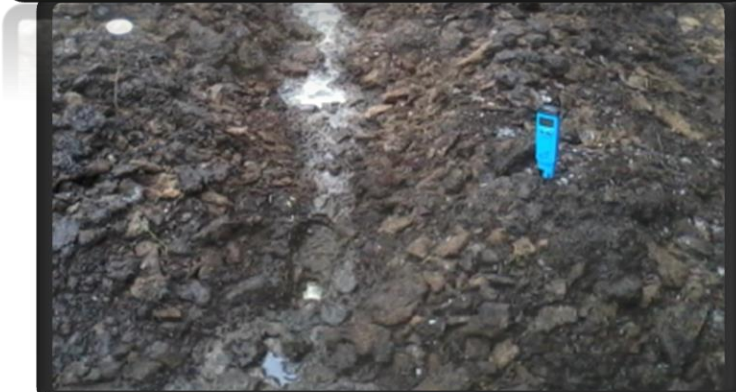
FIGURA 2. MEDICION DE TEMPERATURA Y CONDUCTIVIDAD ELECTRICA
